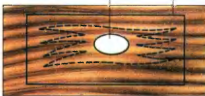
контрольный вырез в поврежденном шпоне лоскут шпона
