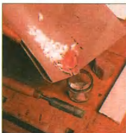
3. Измельченный воск высыпают в стеклянную банку, затем смешивают со скипидаром в равных объемах.
