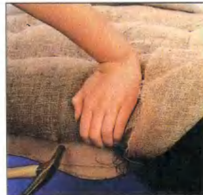
4. После заполнения каркаса обтяните набивку холстом. Края ткани закрепите гвоздями.
