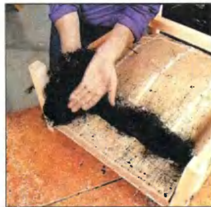
2. Следующий этап – распределение набивки по всему каркасу с протяжкой порциями через петли.
